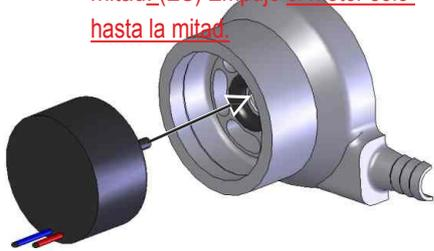
(DT) Aplique un fino cordón de adhesivo alrededor del motor (para sellarlo). Para ello, utilice un adhesivo para rellenar huecos (por ejemplo, Uhu Max Repair Power).
